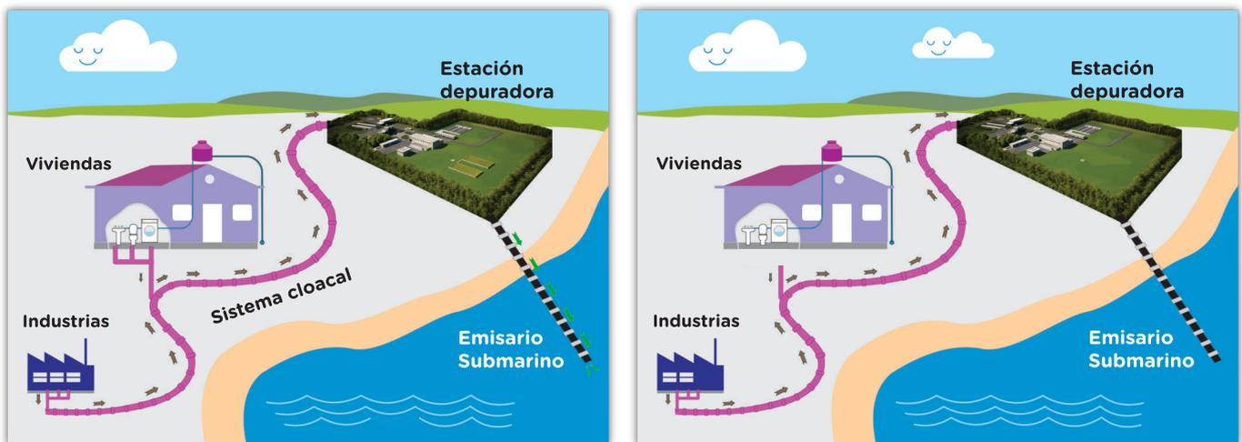
El agua usada en los hogares e industrias, llamada efluente cloacal, es retirada por Obras Sanitarias Mar del Plata - Batán, a través de una compleja red de cañerías (colectoras y cloacas máximas), ayudada por estaciones elevadoras, hasta una Estación Depuradora, donde se separan las grasas y los sólidos.
